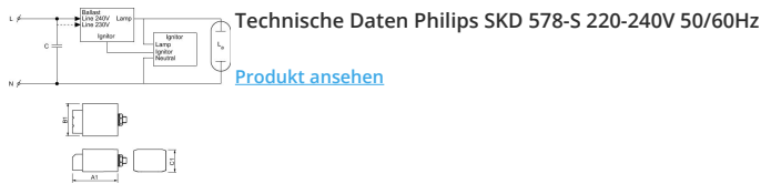
Technische Daten Philips SKD 578-S 220-240V 50/60Hz
